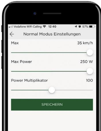
Anpassung der Motorkraft und der max. Geschwindigkeit
